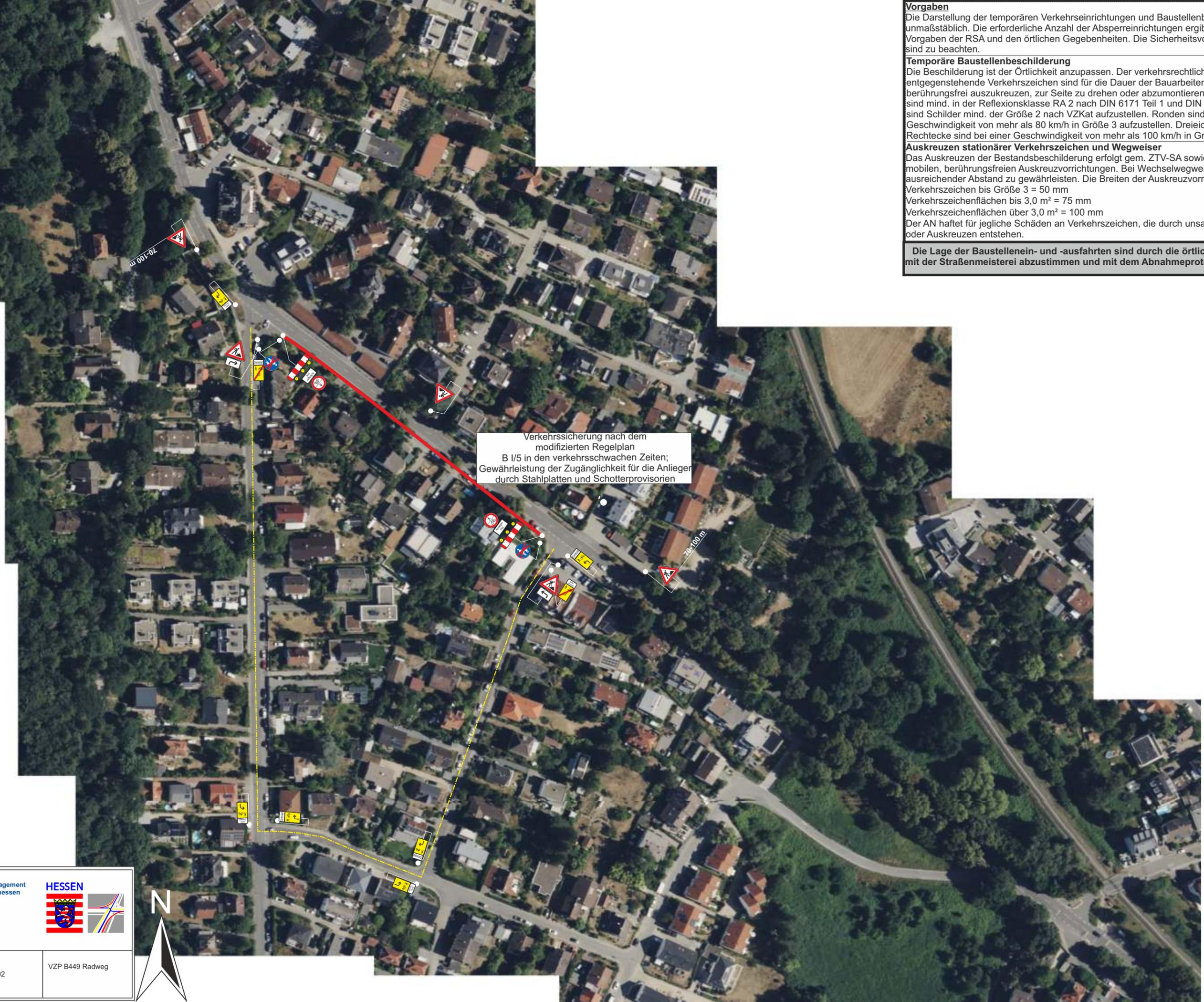
Verkehrssicherung nach dem modifizierten Regelplan B I/5 in den verkehrsschwachen Zeiten; Gewährleistung der Zugänglichkeit für die Anlieger durch Stahlplatten und Schotterprovisorien
